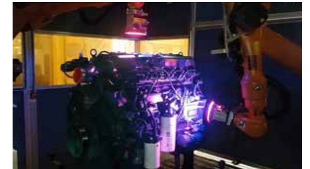
Línea de producción: Sistema de Inspección Visual Electrónico
